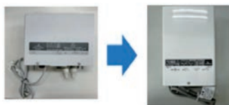
③テレビ、レコーダー機器へ分波器を接続する作業
