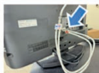
③テレビ、レコーダー機器へ分波器を接続する作業
