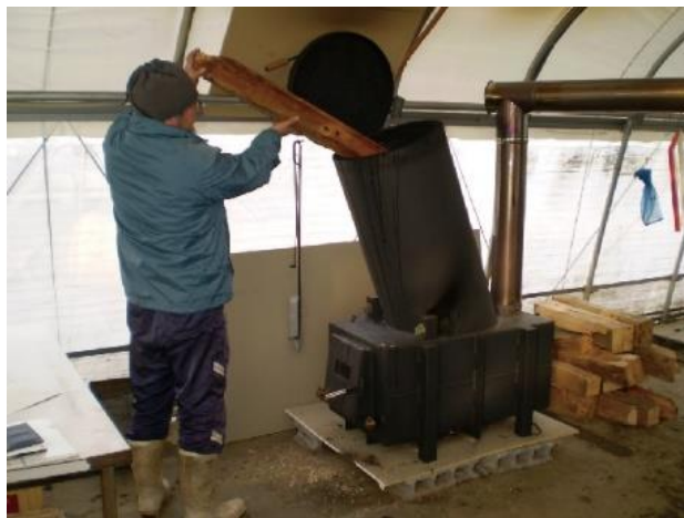
図 55 ビニールハウス用薪ストーブに薪を投入する様子
