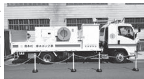
排水ポンプ車
